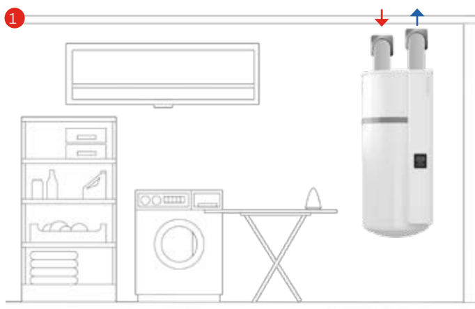
1 Toevoer en afvoer op buitenlucht
